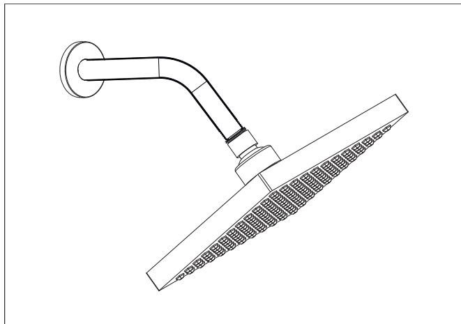
CZ - Přišroubujte horní sprchu, nasuňte krycí růžici tak, aby se plně dotýkala zdi.
