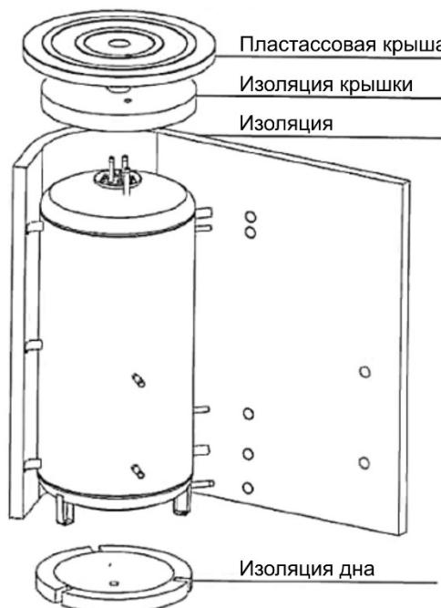
Слой изоляции NEODUL LB PP толщиной 100 мм (1500 l), 120 мм (2000 l). Компоненты изоляции – верхняя крышка, крышка фланцев и заглушки отверстий. Изоляция поставляется в отдельной упаковке.
