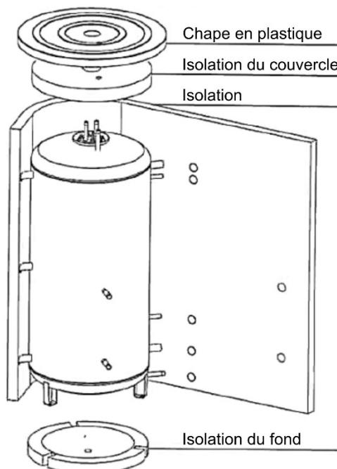
Isolation NEODUL LB PP d'une épaisseur de 100 mm (1500 l), 120 mm (2000 l). Le couvercle supérieur, le couvercle des brides et les bouchons des orifices en sont des éléments constitutants. L'isolation est livrée emballée séparément.
