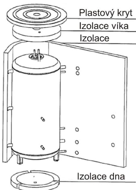
Izolace NEODUL LB PP o síle 100mm (1500 l), 120 mm (2000 l). Součástí jsou horní kryt, kryt přírub a krytky otvorů. Izolace se dodává samostatně zabalena.
