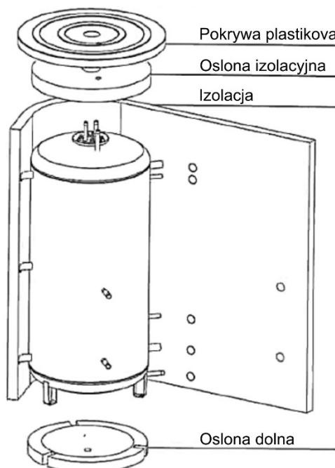
Izolacja NEODUL LBPP o grubości 100mm (1500 l), 120 mm (2000 l). Część składową tworzą pokrywa górska, pokrywa kołnierzowa oraz pokrywki otworów. Izolacja dostarczana jest w osobnym opakowaniu.
